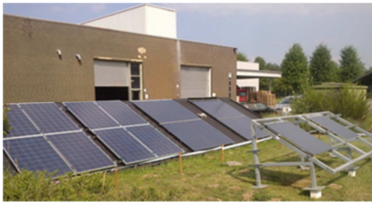
Figuur 2 – Direct vergelijk tussen zes verschillende systeemconcepten met variërende mate van (dak)integratie en ventilatie.
